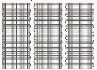
Heizdraht oder Heizschlaufe 5 mm - 30 mm Ø
